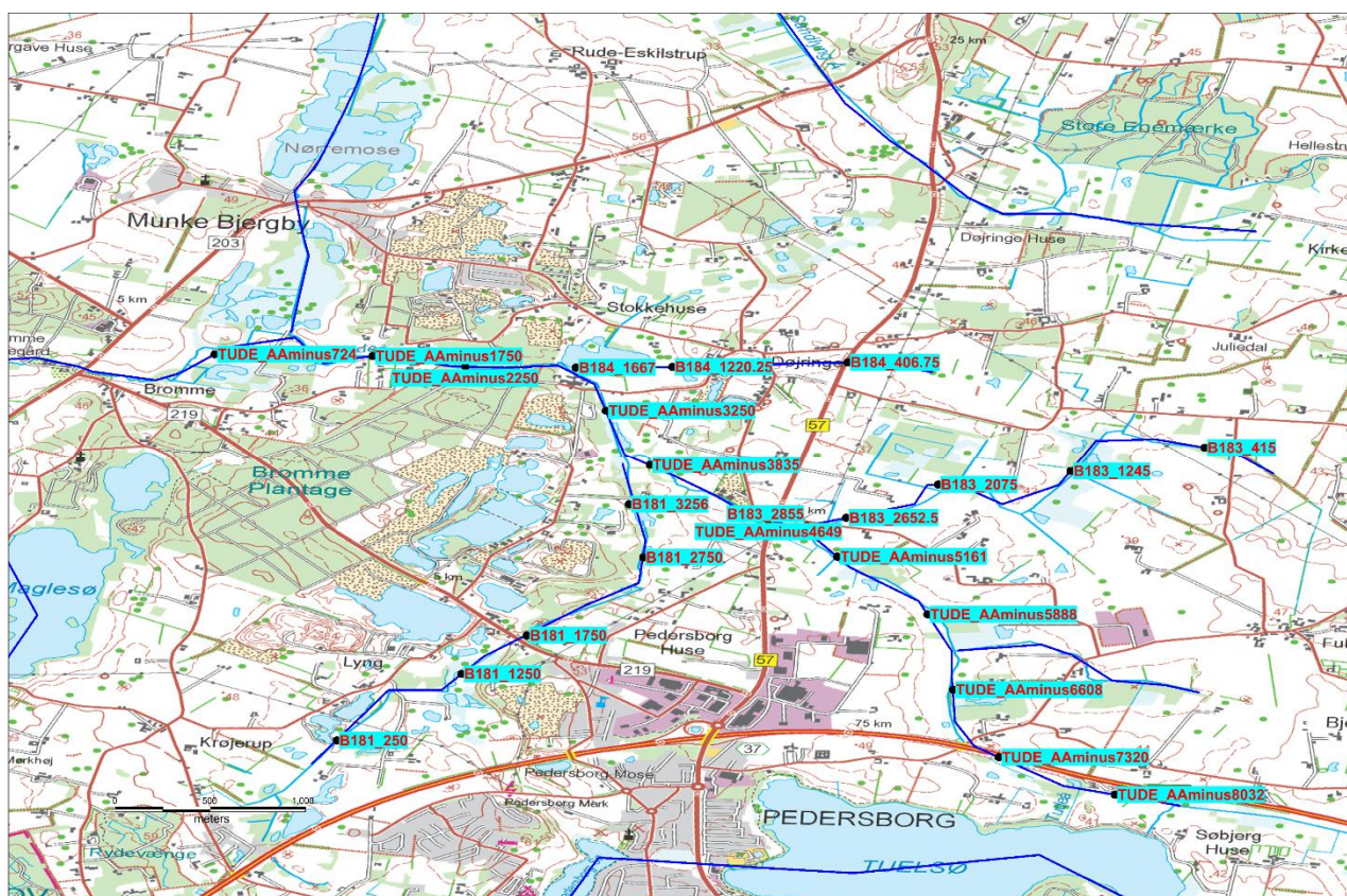
Figur 5-1 Q-punkter i vandløbsmodellen, hvor vandføringen er udtrukket. Vandløbet B181 er Lyngbækken. Kortet ses i større udgave i Bilag 11.
